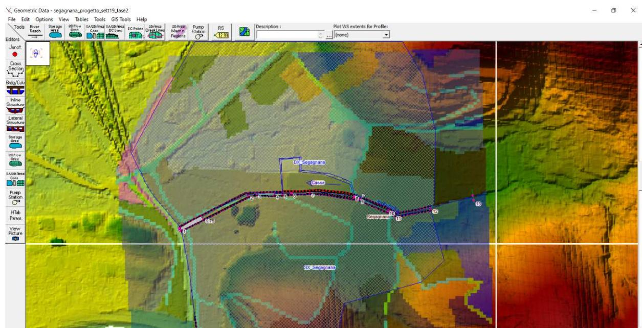
Figura 12 - Esempio di associazione dei valori di scabrezza secondo Manning della pianura tramite il relativo codice Corine effettuato tramite Hec Ras
