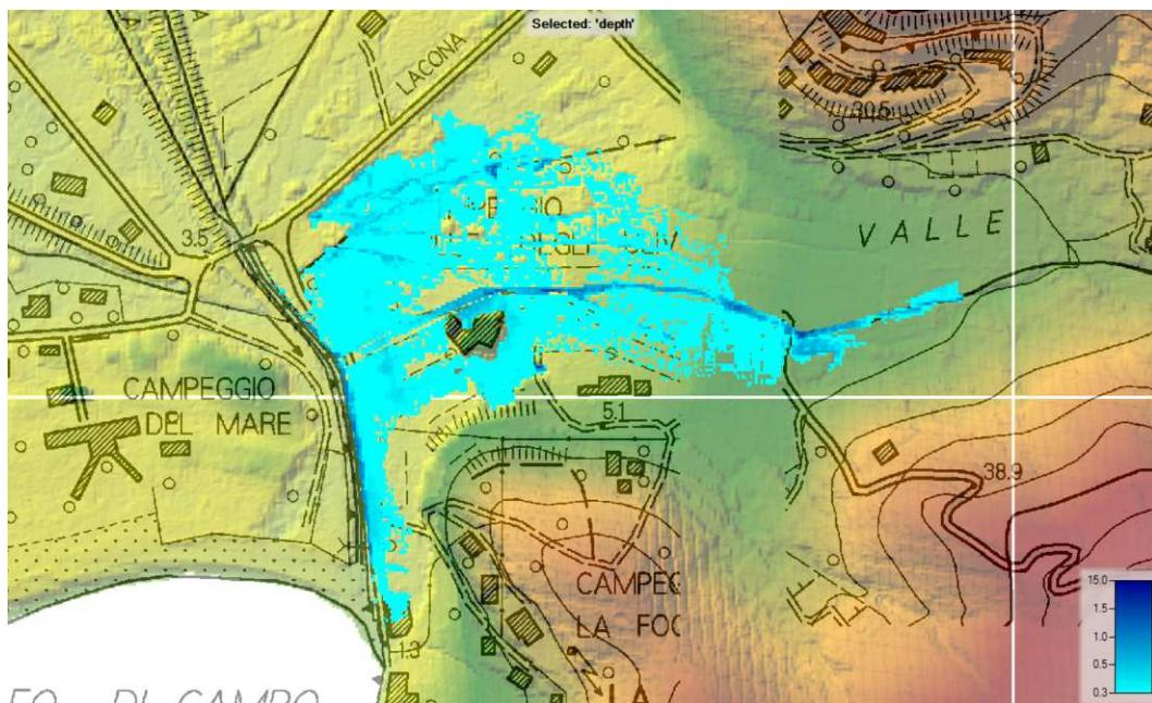
Figura 21 – Inviluppo delle massime altezze d'esondazione per Tr 30 anni sbocco rigurgitato
